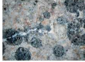
شكل (٨) تنتج البكتريا كربونات الكالسيوم التي تسد الشقوق
