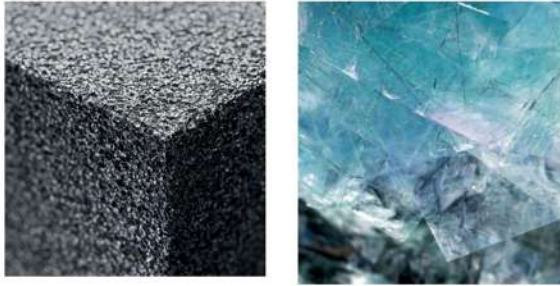
شكل (٤) مادة Foamglas T4+ مصنوعة من زجاج معاد تدوير بنسبة ٦٠%
