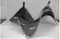
شكل (48) شكل البوليمرات عند تعرضها للطاقة الكهربائية.
