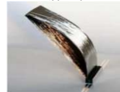
شكل (43) انحناء المطاط نتيجة التعرض لطاقة حرارية.
