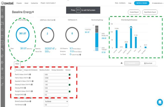
شكل 29: بيانات النموذج النانوي أثناء إدخال معامل النفاذية الحرارية للحوائط والسقف والزجاج وتأثيرها على انخفاض كثافة استخدام الطاقة EUI
